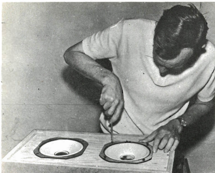
Fig. 4 - Insieme agli altoparlanti vengono forniti dadi a T e viti per il loro fissaggio. Si noti che gli altoparlanti LE8T e PR8 sono costruiti per essere montati proprio attraverso la parte anteriore del pannello frontale del mobile.
